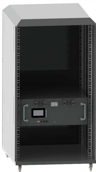
Figura 2-2 Diagrama esquemático da instalação padrão em gabinete
