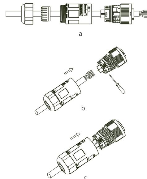
Fig 6.2 Diagrama de fiação de saída CA
