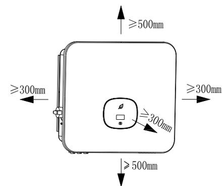
Fig 5.2 Dimensões de instalação de 1 inversor
