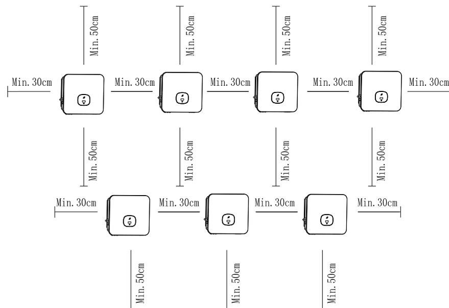
Fig 5.3 Dimensões de instalação de múltiplos inversores
