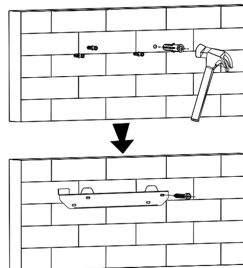
Fig. 5.8 Diagrama esquemático da instalação para montagem na parede
