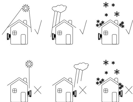
Fig. 5.4 Ambiente de instalação
