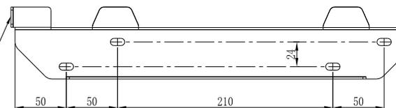
Fig. 5.7 Especificações para montagem na parede
