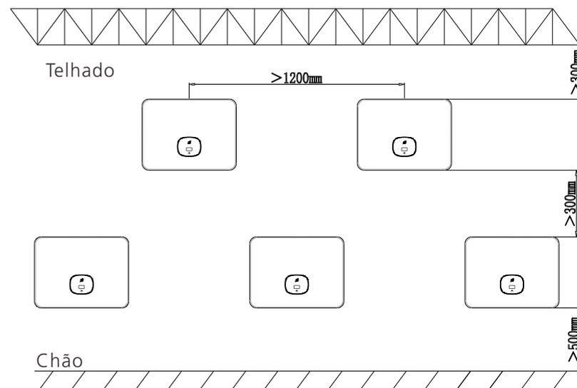
Fig. 5.3 Dimensões de instalação para vários inversores
