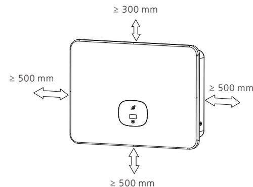
Fig. 5.2 Dimensões de instalação para um inversor
