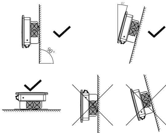
Fig. 5.1 Diagrama de instalação
