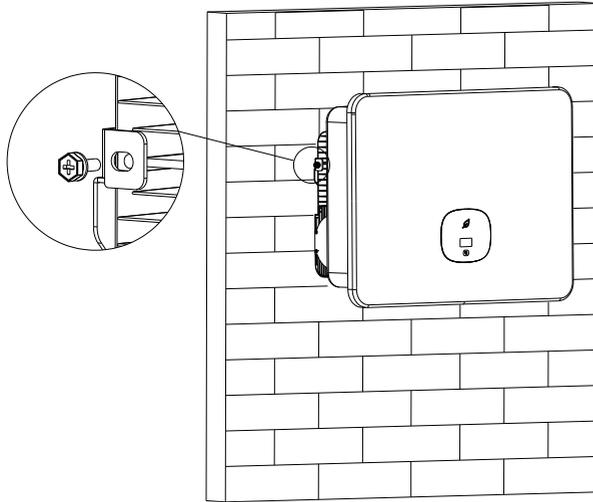
Fig. 5.9 Diagrama esquemático de montagem na parede do inversor
