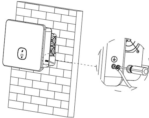
Fig. 6.1 Diagrama de aterramento
