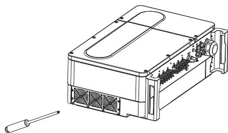
Fig 9.1 Visão do ventilador externo
