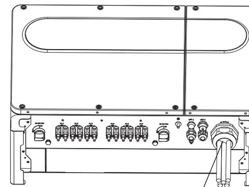
Aperte a tampa à prova d'água
