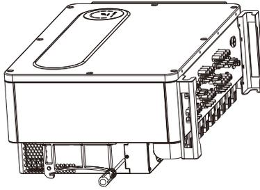
Fig. 9.1 Visão do ventilador externo
