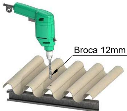
No caso da haste Inox faça um furo na terço usando uma broca de 9,5mm
