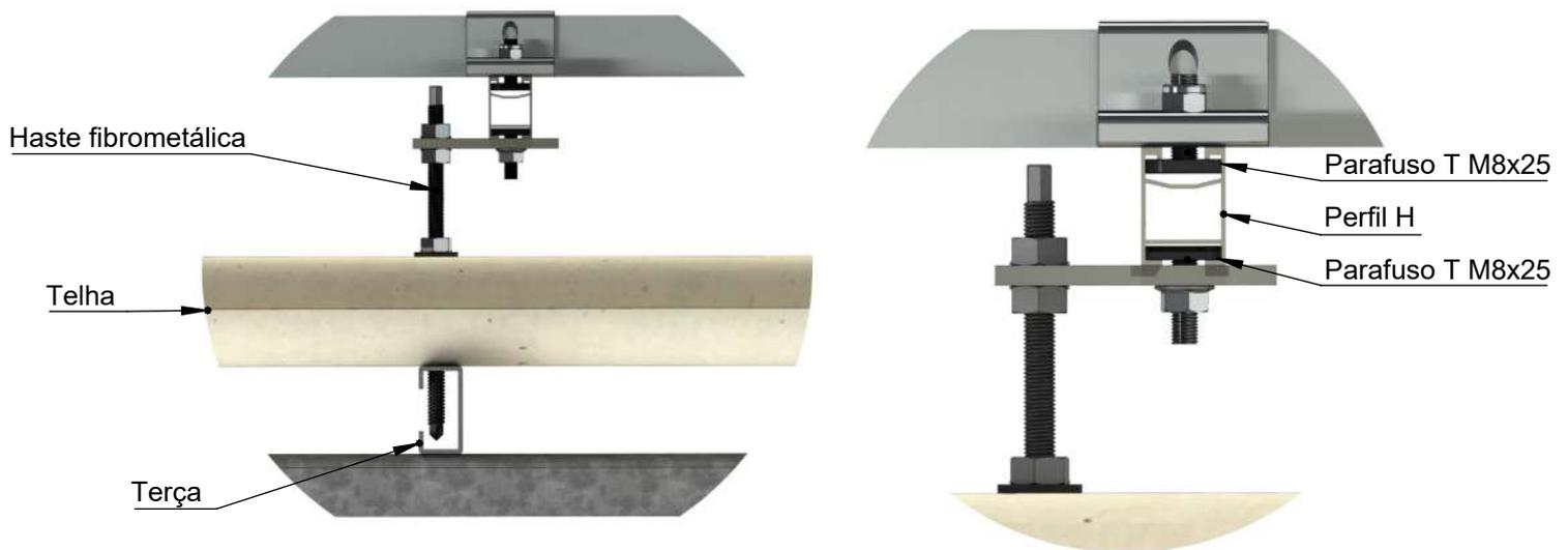
Detalhe "A" vista da fixação da haste
