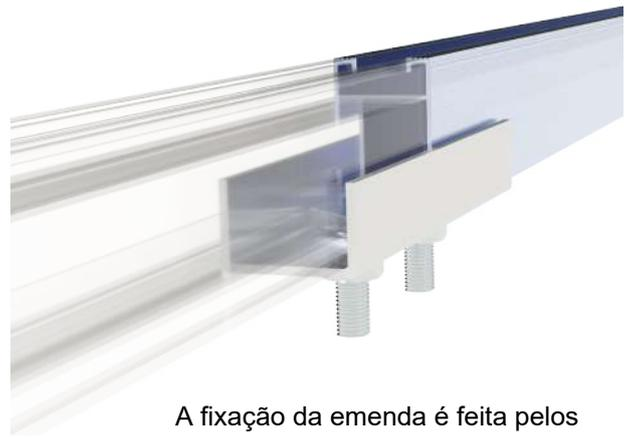
A fixação da emenda é feita pelos parafusos T fixados na parte inferior do perfil
