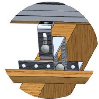
DETALHE "C" IMAGEM ILUSTRATIVA DE FIXAÇÃO
