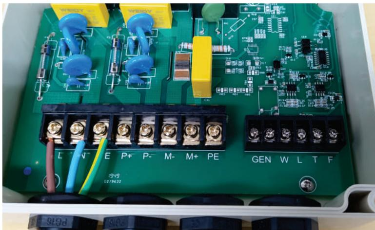
Conecte o polo positivo da placa solar no terminal “P+” e polo negativo da placa solar no terminal “P-”.
