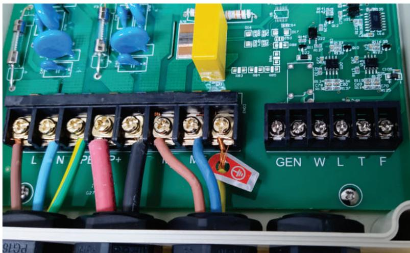
Conecte o sensor do poço: fio preto no terminal “W” e o fio vermelho no terminal “L”.
