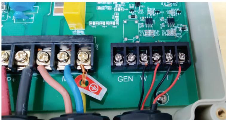
Após conectar todos os terminais, é extremamente recomendado revisar toda a instalação e reapertar todos os terminais.
