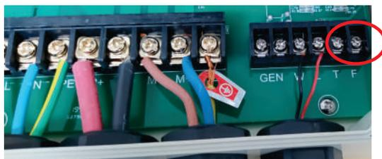
Instalação do controlador sem utilização do sensor de tanque.
