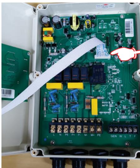
Conecte a fase, neutro e terra da rede elétrica, respectivamente nos terminais “L, N e PE”.
