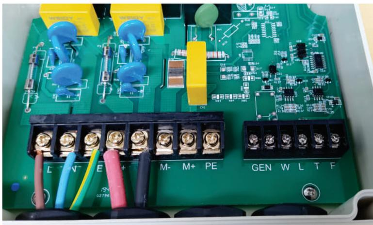
Conecte as fases negativa, positiva e terra do motor da bomba, respectivamente nos terminais “M-, M+ e PE”.
