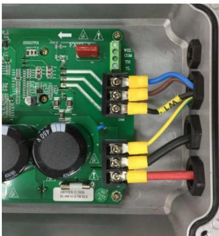
Conecte o sensor do tanque: fio preto no terminal “COM” e o fio vermelho no terminal “TH”
