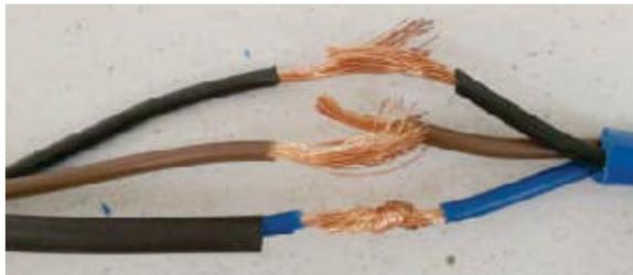
**Passo 2.** Cubra a junta com um pequeno tubo retrátil.
