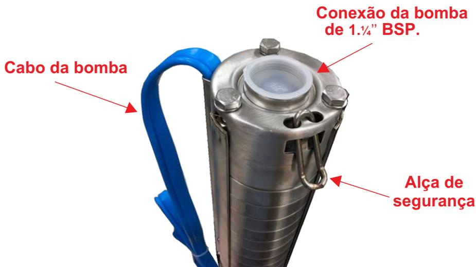
Para instalações em poços artesianos é recomendado o uso de tubos geomecânicos (pvc) ou tubos galvanizados. Evitar o uso de luvas e reduções na saída da bomba. A bomba possui alça de segurança para quando instaladas em grandes profundidades, em caso de rompimento do cano, ser possível resgatar a bomba. Pode ser utilizado cabo de aço ou corda de nylon.
