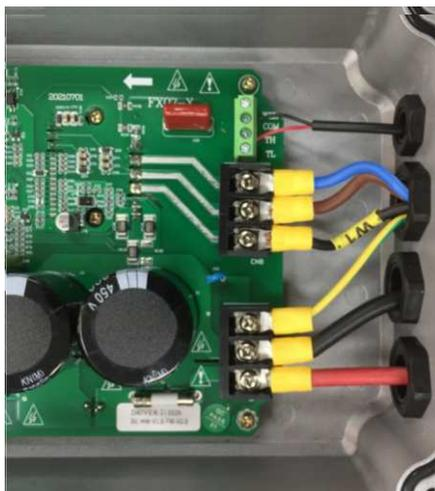
Após conectar todos os terminais, é extremamente recomendado revisar toda a instalação e reapertar todos os terminais.
