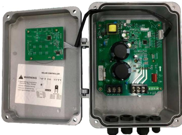
Conecte o Polo positivo da placa solar no terminal “DC+”.
