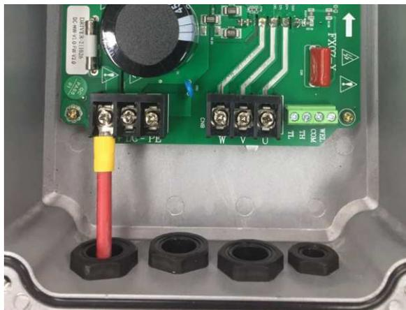
Conecte o Polo negativo da placa solar no terminal “DC-”.
