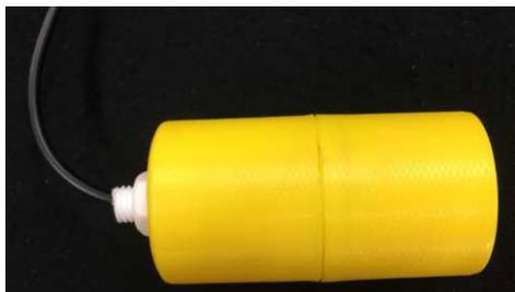
**Sensor do nível do tanque:** O sensor do nível do tanque é usado para detectar o nível de água no tanque e evitar que o nível de água fique muito alto e transborde. Quando o tanque estiver cheio, o sensor desliga a bomba. Assim que o tanque estiver com o nível abaixo do sensor, ele liga novamente a bomba após 5 minutos.
