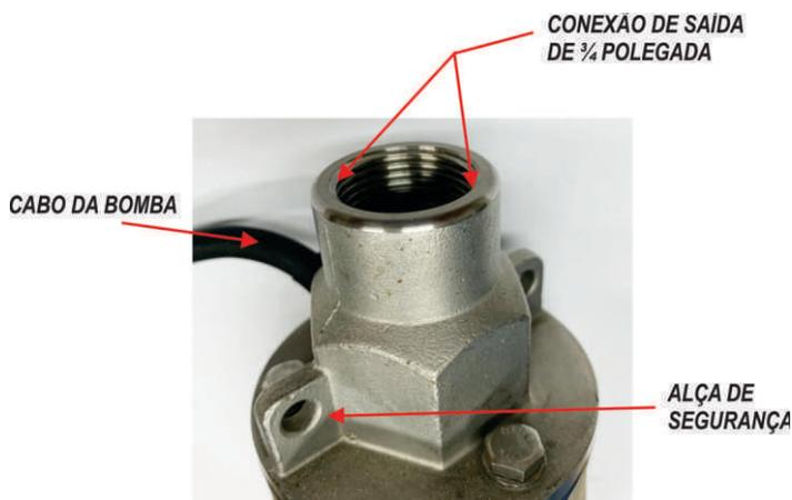
Para instalações em poços artesanais é recomendado o uso de tubos geomecânicos (pvc) ou tubos galvanizados. Evitar o uso de luvas e reduções na saída da bomba. A bomba possui alça de segurança para quando instaladas em grandes profundidades, em caso de rompimento do cano, ser possível resgatar a bomba. Pode ser utilizado cabo de aço ou corda de nylon.
