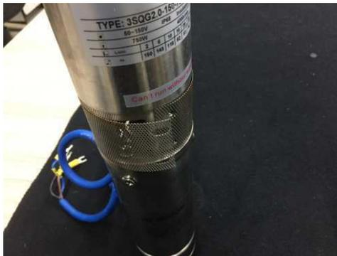
**Passo 4.** Em seguida, com a chave de boca 10 mm, retire os parafusos de dentro do filtro e puxe manualmente a camisa da bomba.
