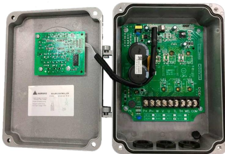
Conecte o Polo positivo da placa solar no terminal “P+”.
