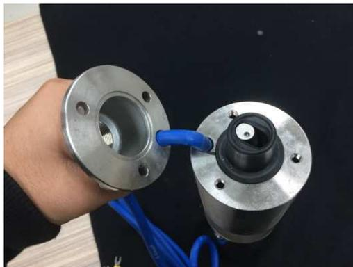
**Passo 2.** Retire manualmente o impulsor e substitua-o se necessário.
