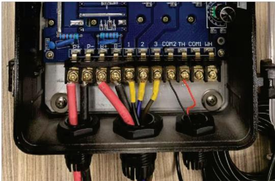
Conecte o sensor do poço: fio preto no terminal “COM1” e o fio vermelho no terminal “WH”.
