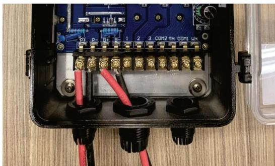
Conecte as fases “1, 2 e 3” do motor da bomba respectivamente nos terminais “1, 2 e 3”.
