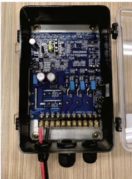
Conecte o polo positivo da bateria no terminal “B+” (em caso de uso de banco de baterias).
