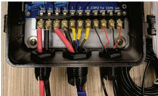
Após conectar todos os terminais, é extremamente recomendado revisar toda a instalação e reapertar todos os terminais.
