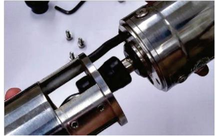
**Passo 5.** Por último, com a chave ½ polegada ou 13mm fixe a base do eixo e desrosqueie manualmente o helicoidal e substitua -o. **OBSERVAÇÃO:** A rosca do helicoidal é esquerda, ou seja, rosqueia no sentido anti -horário e desrosqueia no sentido horário, ao contrário das outras roscas nos parafusos já retirados.
