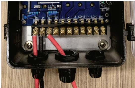
Conecte o polo negativo da bateria no terminal “B -” (em caso de uso de banco de baterias).
