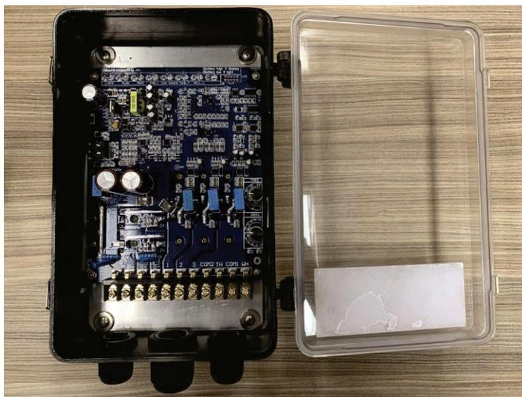
Conecte o Polo positivo da placa solar no terminal “P+”.
