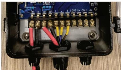
Conecte o sensor do tanque: fio preto no terminal “COM2” e o fio vermelho no terminal “TH”.
