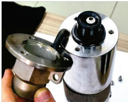
**Passo 2.** Retire manualmente o impulsor e substitua-o se necessário.
