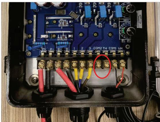
Instalação do controlador sem utilização do sensor de tanque.
