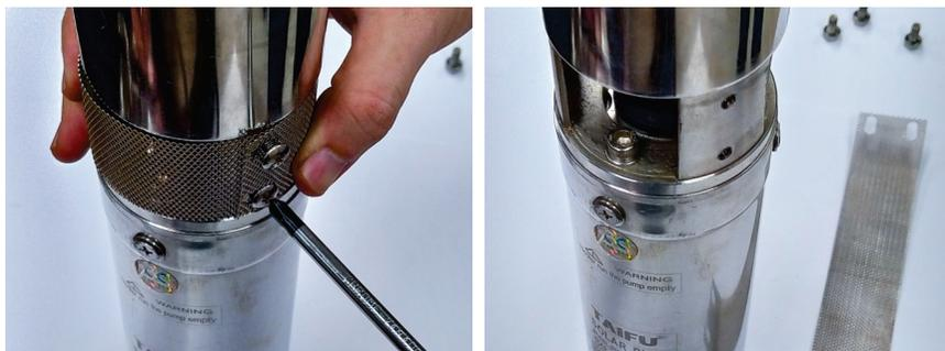
**Passo 4.** Em seguida, com a chave allen 5mm, retire os parafusos de dentro do filtro e puxe manualmente a camisa da bomba.
