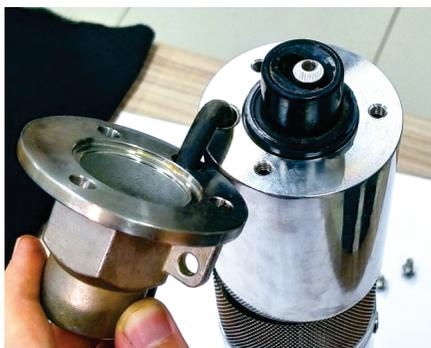
**Passo 2.** Retire manualmente o impulsor e substitua-o se necessário.
